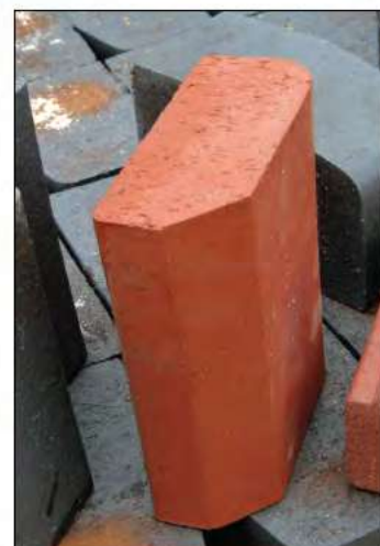
MILEN I RUDGWICK, HVOR KLINKERNE BRÆNDES VED, AT IBLANDET SAVSMULD ANTÆNDES. NEDERST TV.: FÆRDIGE STEN FRA MILEN. TH.: FORMSTEN FRA OVNE I KINGSBURY.
