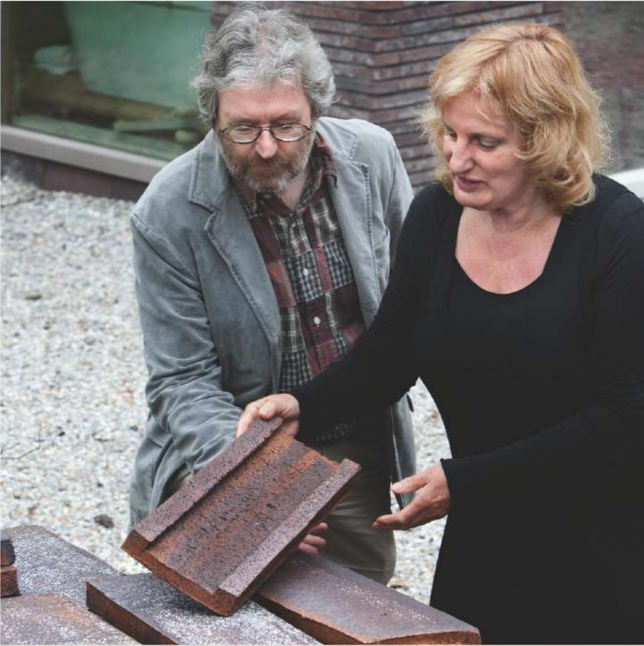
Med udgangspunkt i Kolumba udviklede Jetty og Maarten Min en specialsten til deres eget hus. Stenen er 100 mm bredere end Kolumba og udført med fordybning på den indvendige side, så den kan fastgøres til facadekonstruktionens træskelet.
