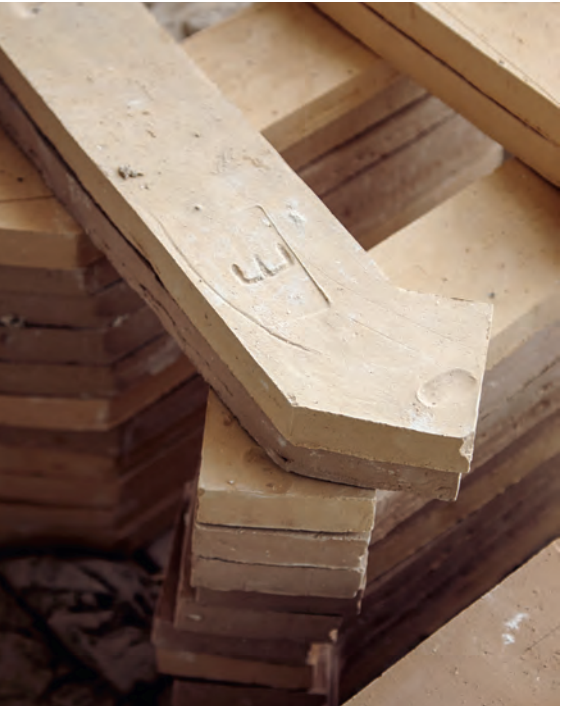
For at løse de mange, krævende detaljer blev der i alt fremstillet 85.890 Kolumbasten i 27 speciallavede udgaver. Det havde ikke været muligt med en industrifremstillet sten.
